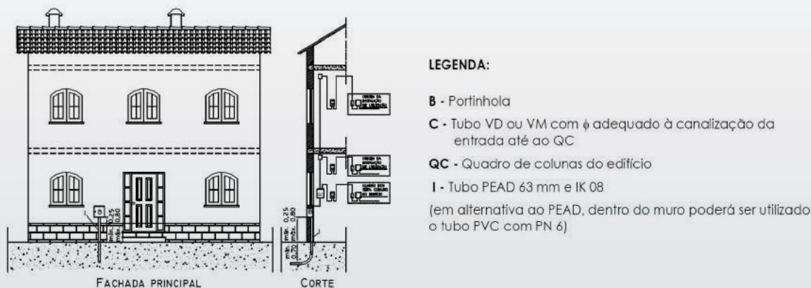
Figura 5.12 – Ligação a partir de rede subterrânea de edifícios coletivos sem muro
