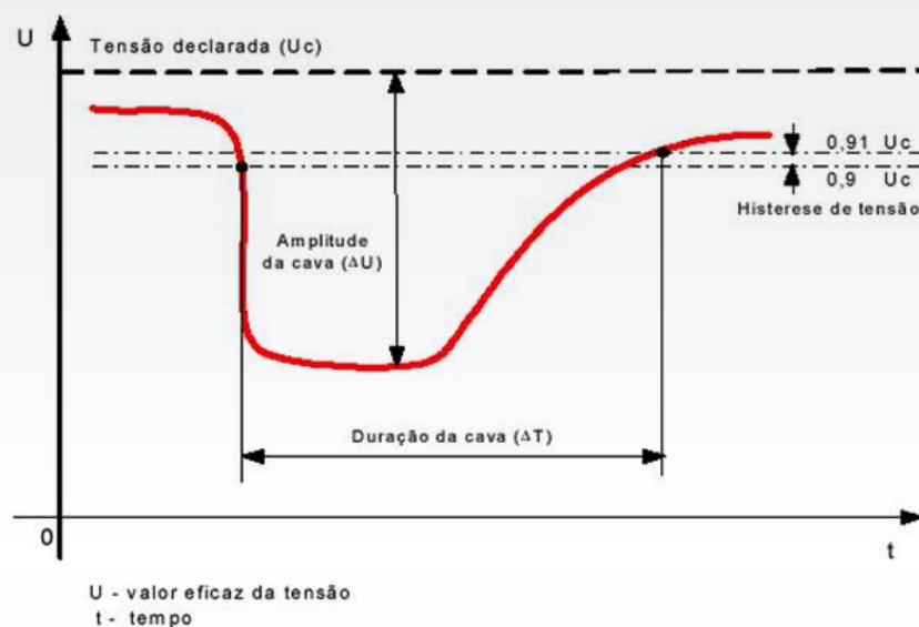
Figura 12.3 – Exemplo de uma cava de tensão
